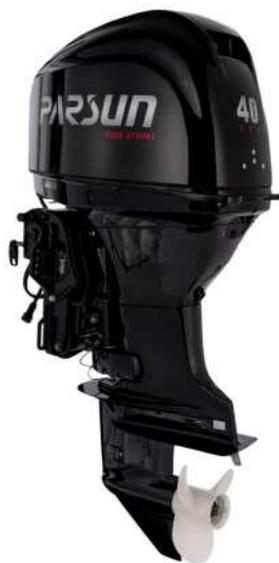
4-тактный мотор с запрограммированным электронным впрыском топлива (EFI), контролируемый системой DELPHI. Электронная система впрыска топлива (EFI) автоматически регулирует состав топливно-воздушной смеси для быстрого и легкого запуска и прогрева мотора.
